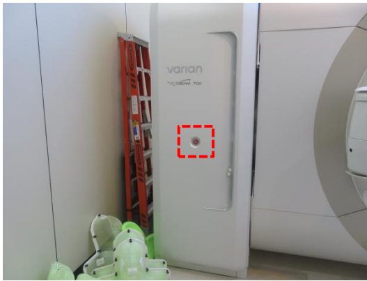
图 3-10 加速器机头北侧急停按钮
